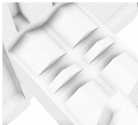
Aussparung für Bewehrungsseisen zur leichteren Verlegung
